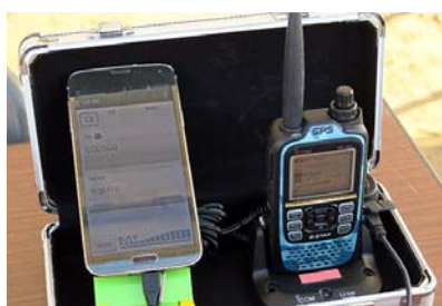
実際に会場で表示された受信画像と、位置情報をマッピングした地図。いずれもD-STAR用のアプリケーション:RS-MS1Aを利用。
