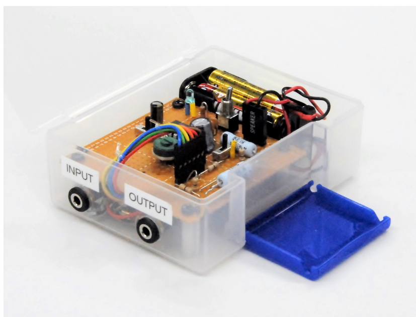
図1 LM386 を使ったオーディオ・アンプの完成品
