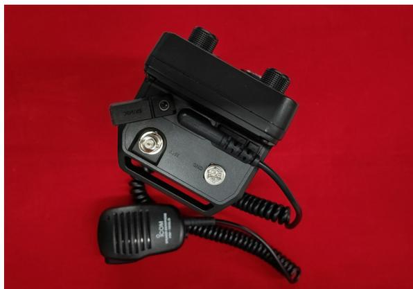
ハンディ機用のスピーカーマイク HM-186LS を IC-705 に挿入した様子。
