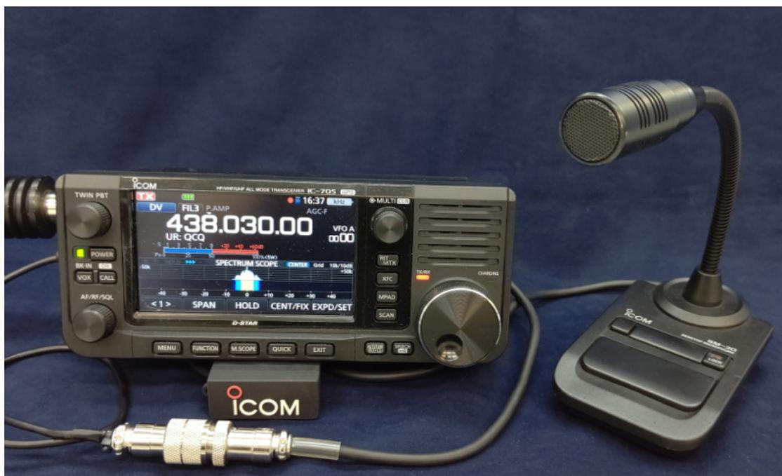
完成した変換ケーブルを使って SM-30 を接続し、送信している状態。
