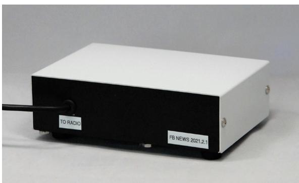
図2 完成したマイクセレクトタのリヤパネル
