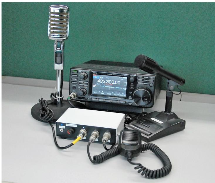
図3 三種類のマイクを製作したマイクセレクトタに接続
