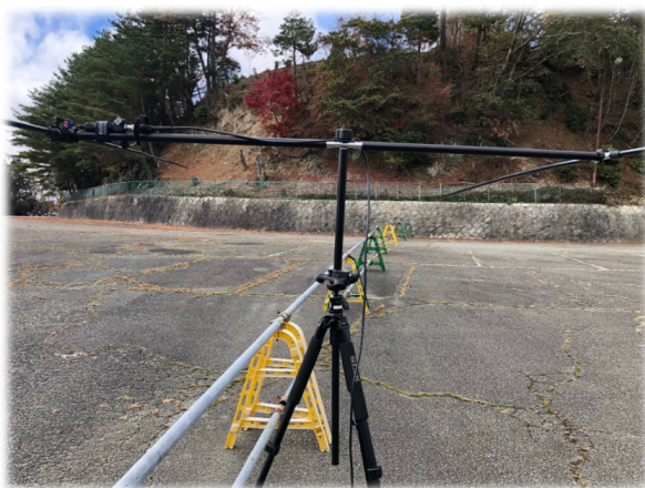
妙見山 (大阪府豊能郡) での運用に使用した 6m バンド 2 エレ八木アンテナ
