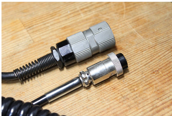
U-229 型コネクター。アマチュア無線機で使う金属コネクター(手前)よりも大きくて重い
