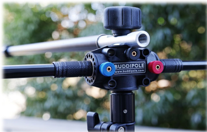
左右の放射器エレメントと導波器側のブームを取付けたところ
