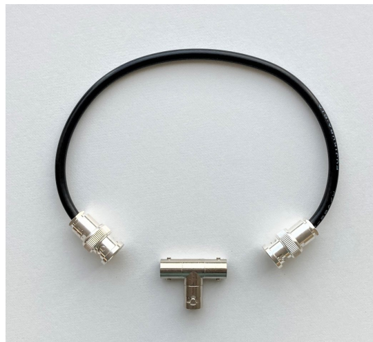
図6 完成した給電ループ
