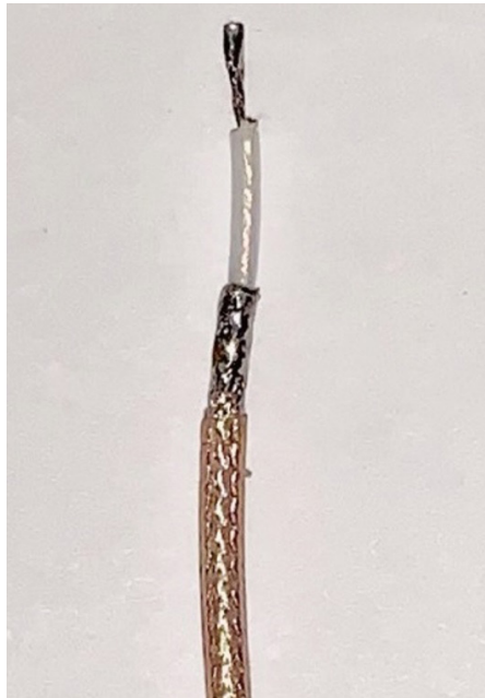
写真 K 同軸ケーブルの外被を剥がす
