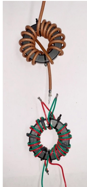
写真 L 完成したバランの結線
