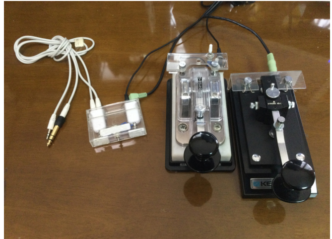
写真 13 無線機 - 接続ボックス - 電鍵との接続イメージ
