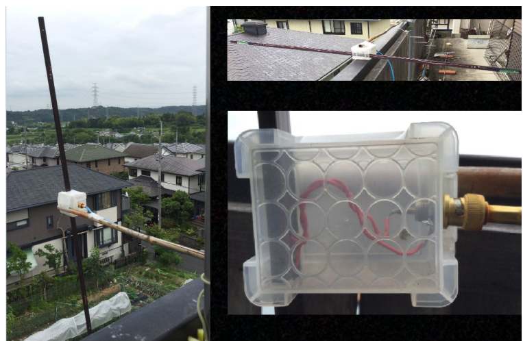
写真1 144MHz/430MHz自作ダイポール (左: ベランダ実装、右上: 正面から、右下: 給電部)
