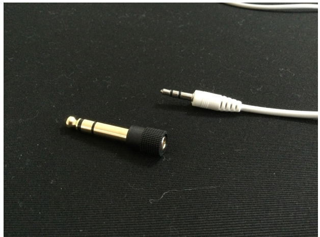
写真3 電鍵用プラグ径変換アダプタ
