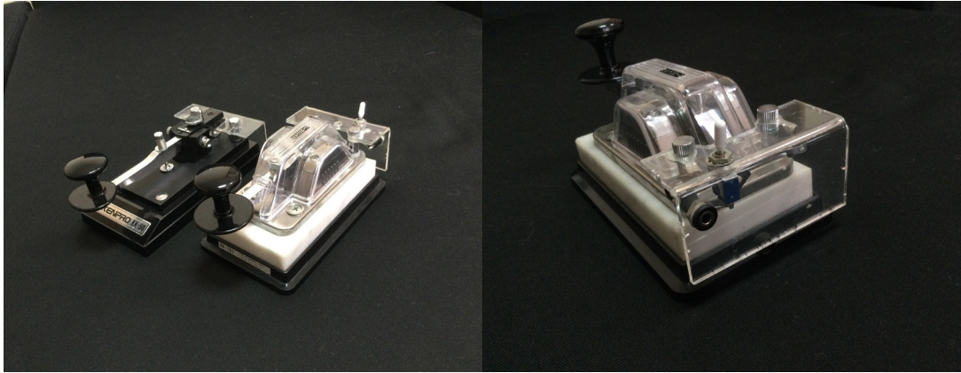
写真10 L字板の電鍵への取り付け、(左 a) 前面、(右 b) 背面
