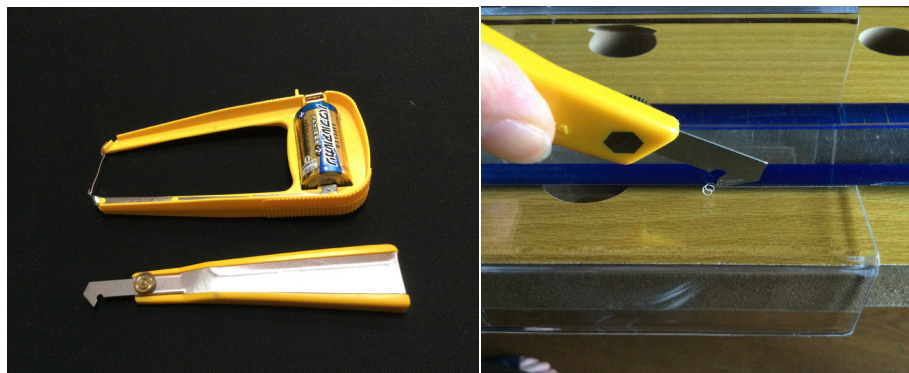
写真8 (左a) プラスチックカッター（下）とスチロールカッター（上）、 (右b) プラスチックカッターによる切断
