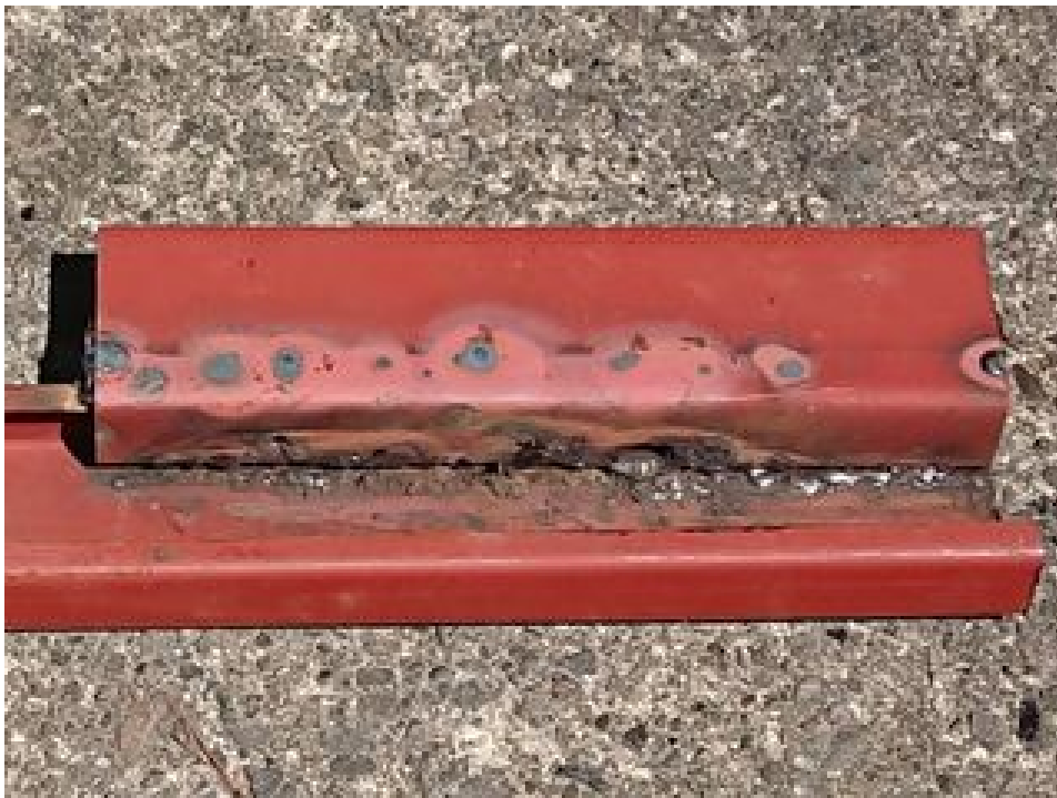
余った鋼材を使って初めての溶接練習。お約束のボロボロ状態
