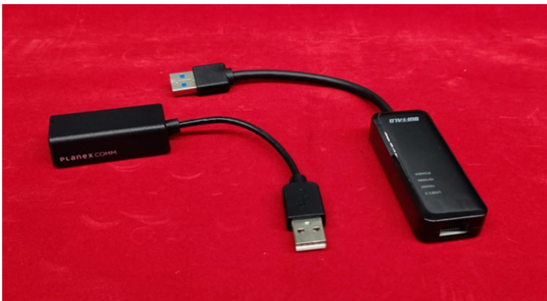
図 2 USB-RJ45 変換アダプタの例
