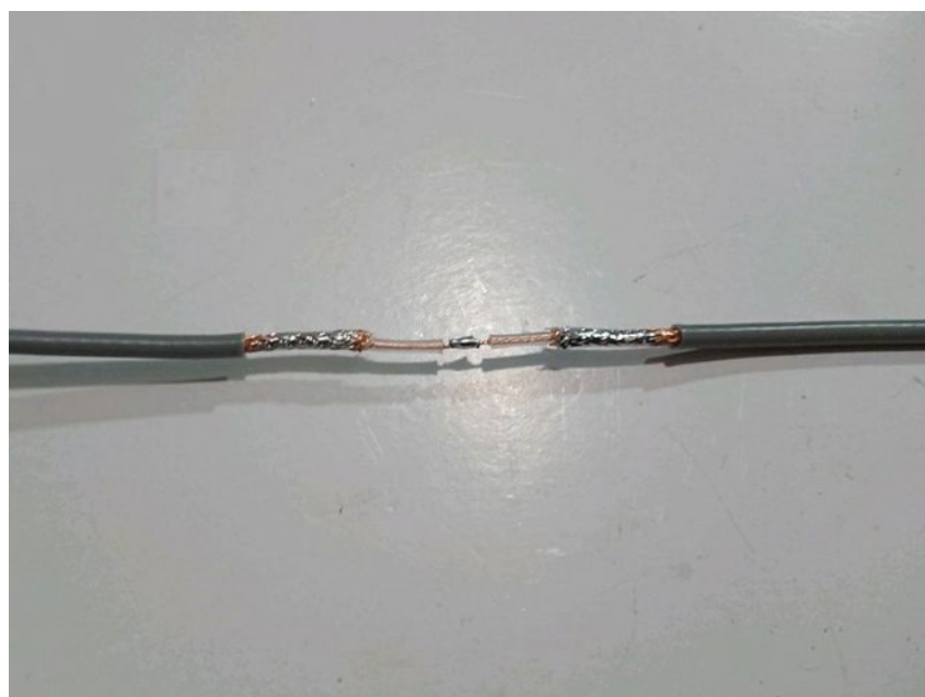
910mm 長の同軸の心線を突き合わせてハンダ接続
