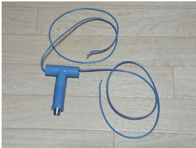
給電部と同軸エレメント部分が完成
