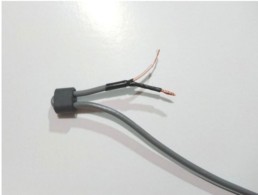
120mm 長の同軸にメガネコアを通し端末加工
