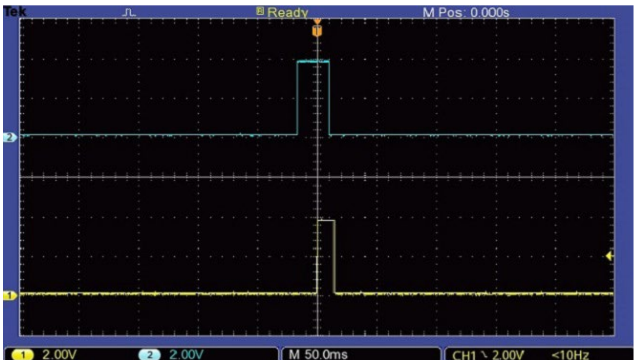
左に 1 クリックしたときの波形(縦軸 2V/div 横軸 50mS/div)
