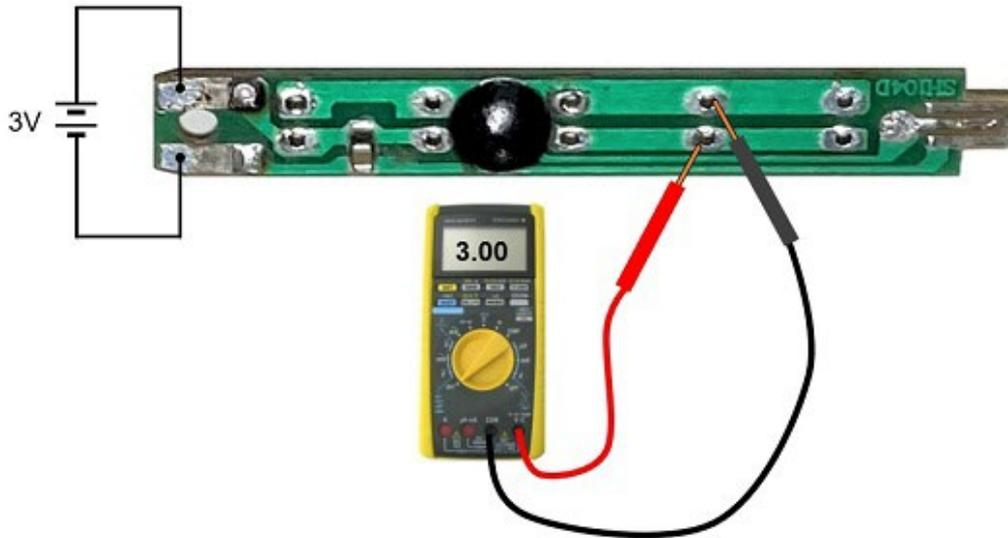
図 6 LED を全部外した状態で出力端子の電圧を測定
